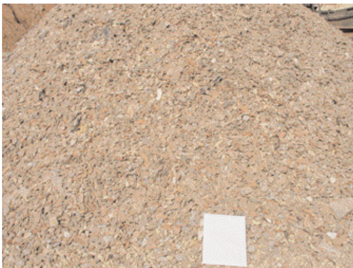
FIGURA 7.- GRANULOMETRÍA 40-60 mm ACOPIADA LISTA PARA SU REUTILIZACIÓN EN LA RESTAURACIÓN DE LA CANTERA DEL CASTELL.
