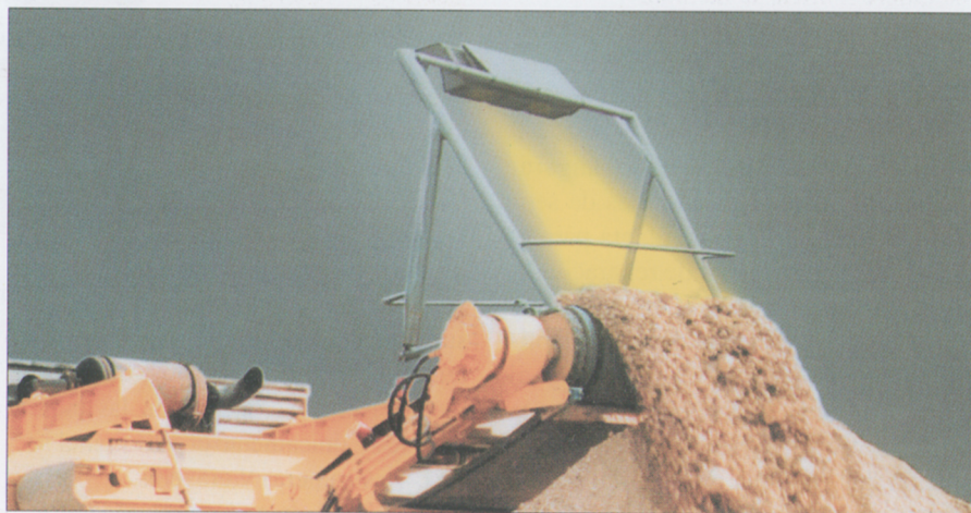
Foto 1.- Esquema de montaje de equipo HARTL SENSORTECHNIK en cinta transportadora. Simulación del haz óptico de lectura volumétrica.
