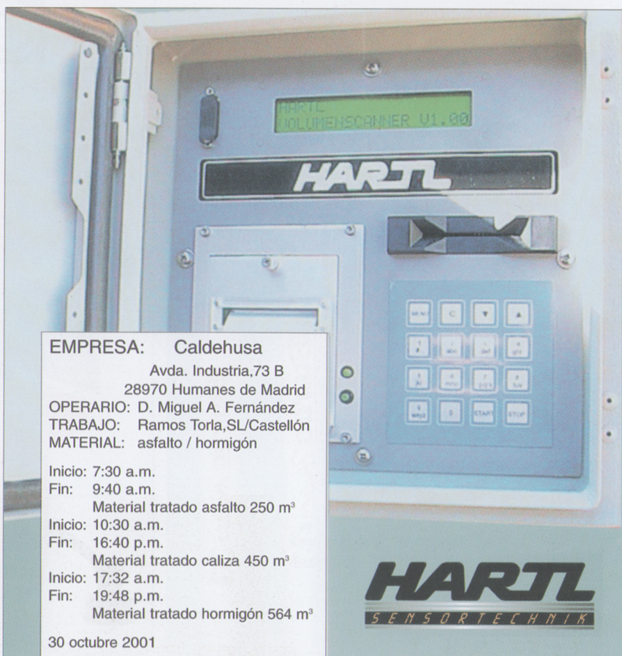
Foto 2.- Vista de detalle de microordenador y de ticket de trabajo de la impresora del HARTL SENSORTECHNIK.
